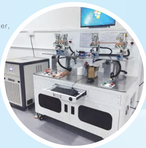
热管Qmax测试 / Heat pipe Qmax test
